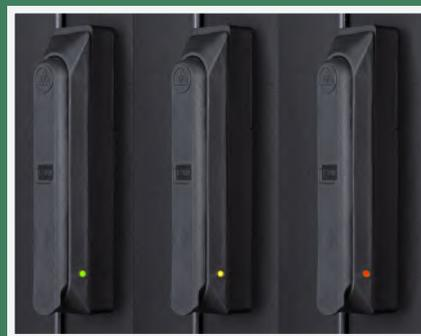
1. Разрешение доступа 2. Связь установлена 3. Запрет доступа
