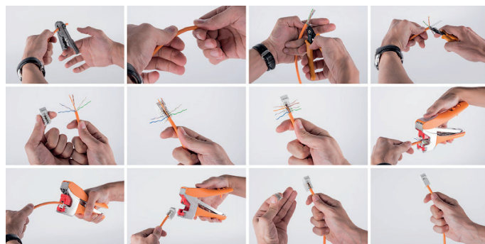
Этапы заделки модуля с помощью FT-TOOL
