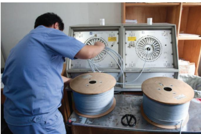
Процесс тестирования кабеля на производстве
