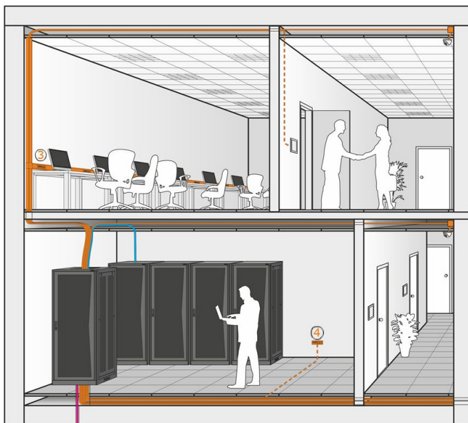
Примеры использования кабельного короба и скрытого монтажа
