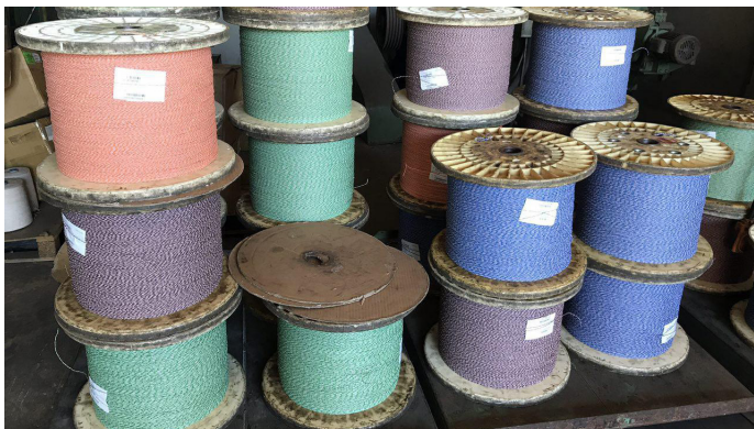
Катушки с изолированными свитыми проводниками
