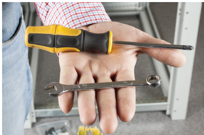
Крестовая отвертка со шлицем rh2 и торцевой ключ на 10 для сборки шкафа
