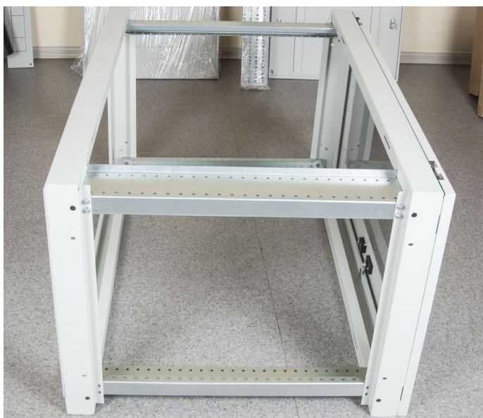
Устанавливаем перемычки между рамами
