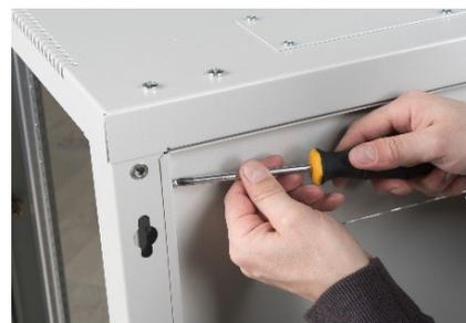
Установка задней стенки
