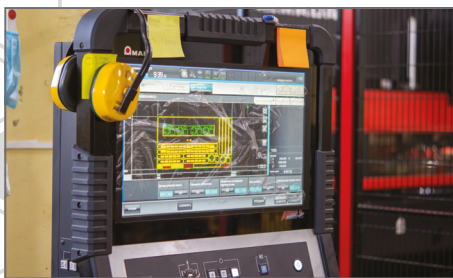
Консоль управления координатно-пробивного пресса
