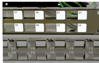
24 гнезда под угловые модули AN пронумерованные с обеих сторон
