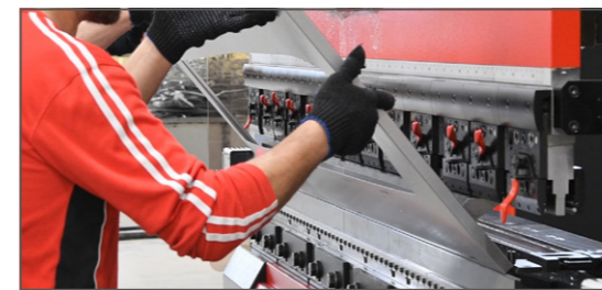
Гибка заготовок в объемные детали
